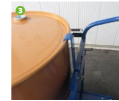
③使用固定装置将油桶固定，以确保移动时稳定
