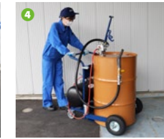
④安装驱动源泵（如气罐等）即可完成
